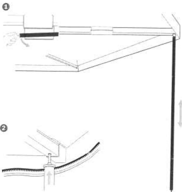
Lösen Sie die Klettverschlüsse an den Stützen und drehen Sie die Stützen senkrecht. Stellen Sie die Höhe der Teleskopstützen durch los/ festdrehen der Stangen ein.
