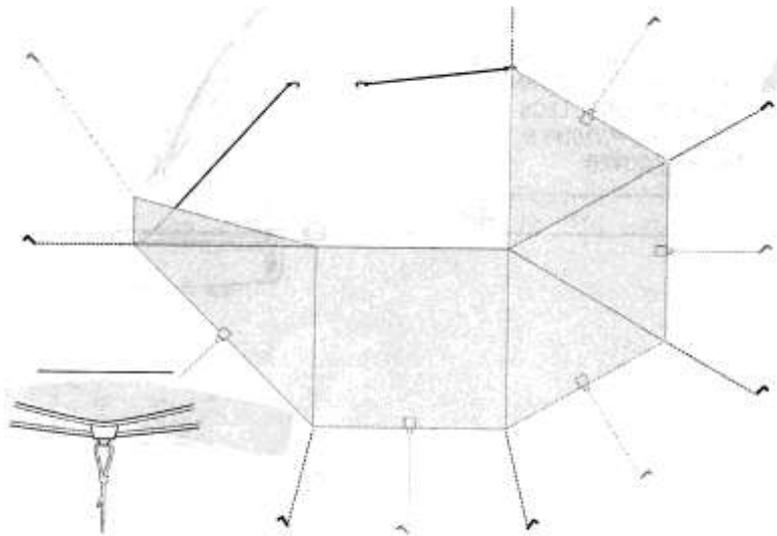
Tip: Bei Regen die Stützbeine absenken, um ein Gefälle zu ermöglichen, und zwischen den Sparren abspannen, um Täler für den Wasserablauf zu bilden.
