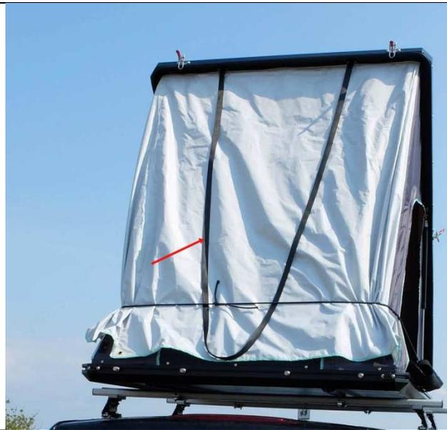
Zunächst werden die Federstangen wieder entfernt. Jetzt kann das Zelt am Gurt an der Stirnseite nach unten gezogen werden.
