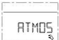
Klicken Sie mit dem Drehschalter das Symbol „Atmos“ an und bestätigen Sie durch klicken. Verwenden Sie den Drehknopf, um zwischen atmosphärischem Druck und Umgebungstemperatur umzuschalten.
