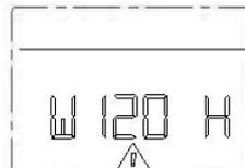
Wird ein Fehler manuell behoben, wird der Fehlercode im Einstellfeld (7) angezeigt, wenn der Fehler auftritt. Die Ursache des Fehlers kann mit Hilfe der Fehlersuche im Handbuch ermittelt und behoben werden. Der Fehlercode verschwindet dann nach ein paar Sekunden, und die Warnung verschwindet. Das Warnsymbol wird aber noch in der Menüleiste angezeigt (4).
