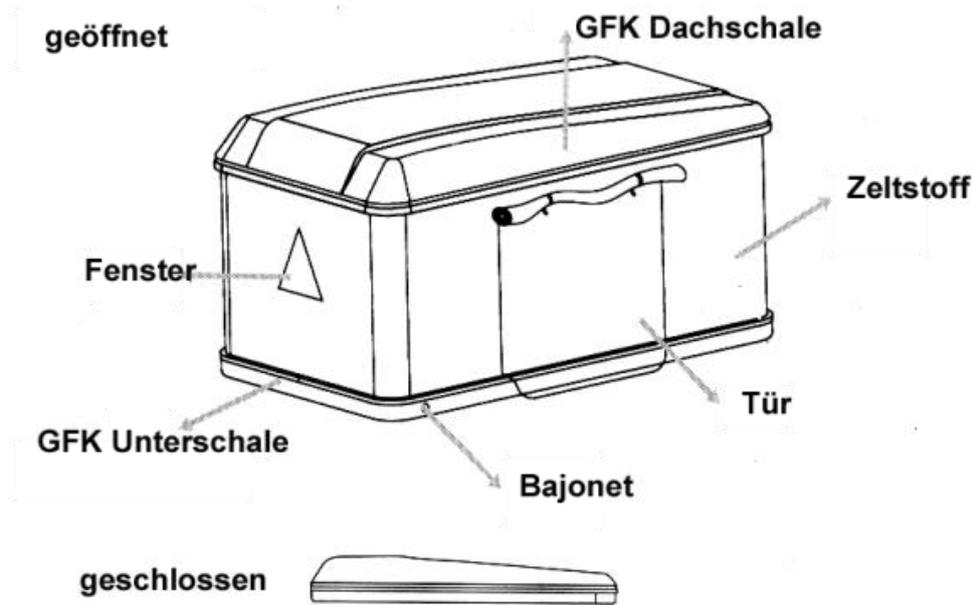
Die Ober- und die Unter-schale des Dachzeltes sind aus glasfaser-verstärktem Kunststoff (GFK) und Aluminiumprofilen gefertigt.
