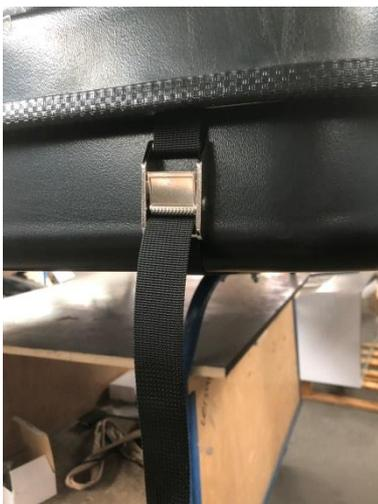
An den Stirnseiten des Zeltes sind vier Spanngurte angebracht. Zum Öffnen des Zeltes lösen Sie diese Gurte und schieben die Oberschale kräftig nach oben. Das Zelt stellt sich dann selbstständig auf.
