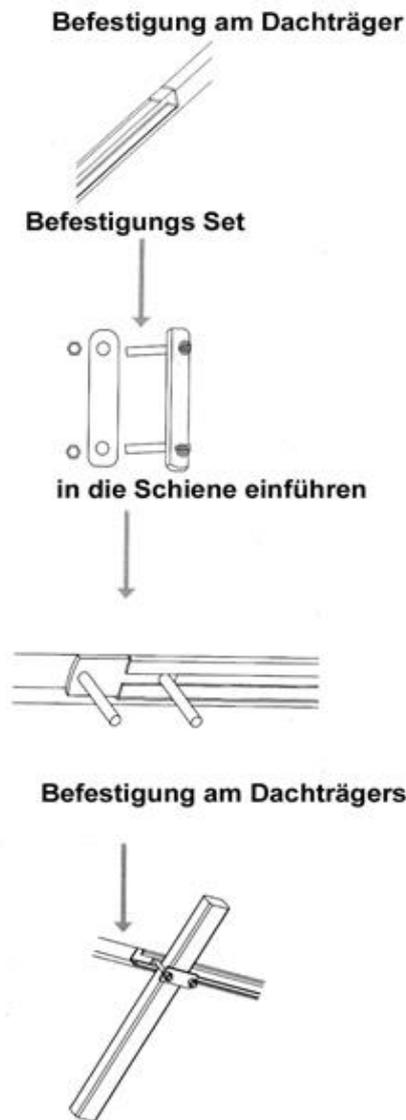
Montieren Sie 2 Schrauben auf eine Montageplatte und schieben Sie diese in die Schiene unter dem Zelt.
