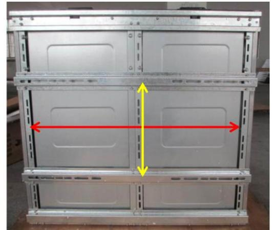
Messen Sie den Abstand zwischen den Schraubpunkten und vergleichen sie diese mit den Montageschienen der Schublade.
