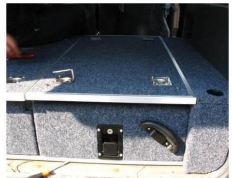
Positionieren Sie die Obere Platte auf der Schublade und schrauben die Inbusschrauben fest.
